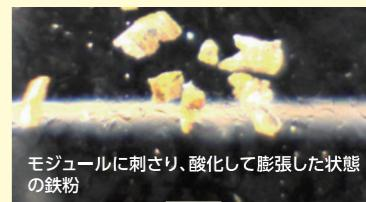
モジュールに刺さり、酸化して膨張した状態の鉄粉
