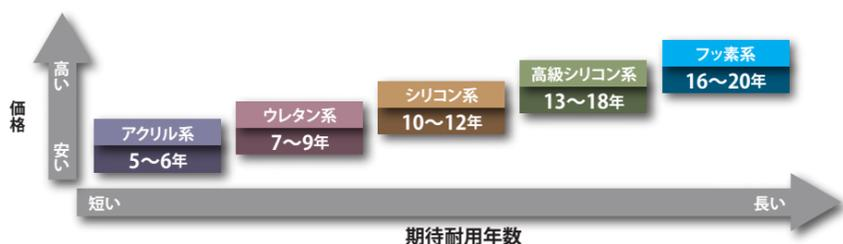
キクスイロイヤルセラクリヤーは耐久年数が高い、高級シリコン樹脂を使用しているため、より長く外壁を保護します。
